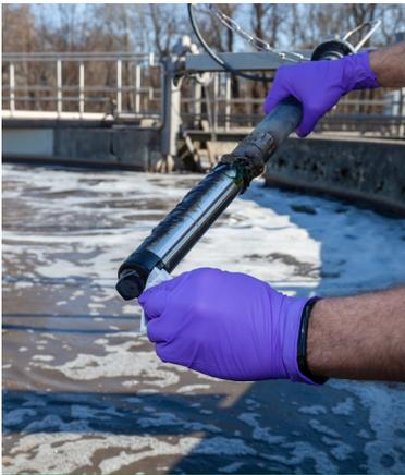
El sensor FDO es fácil de mantener y no requiere calibración por parte del usuario.
